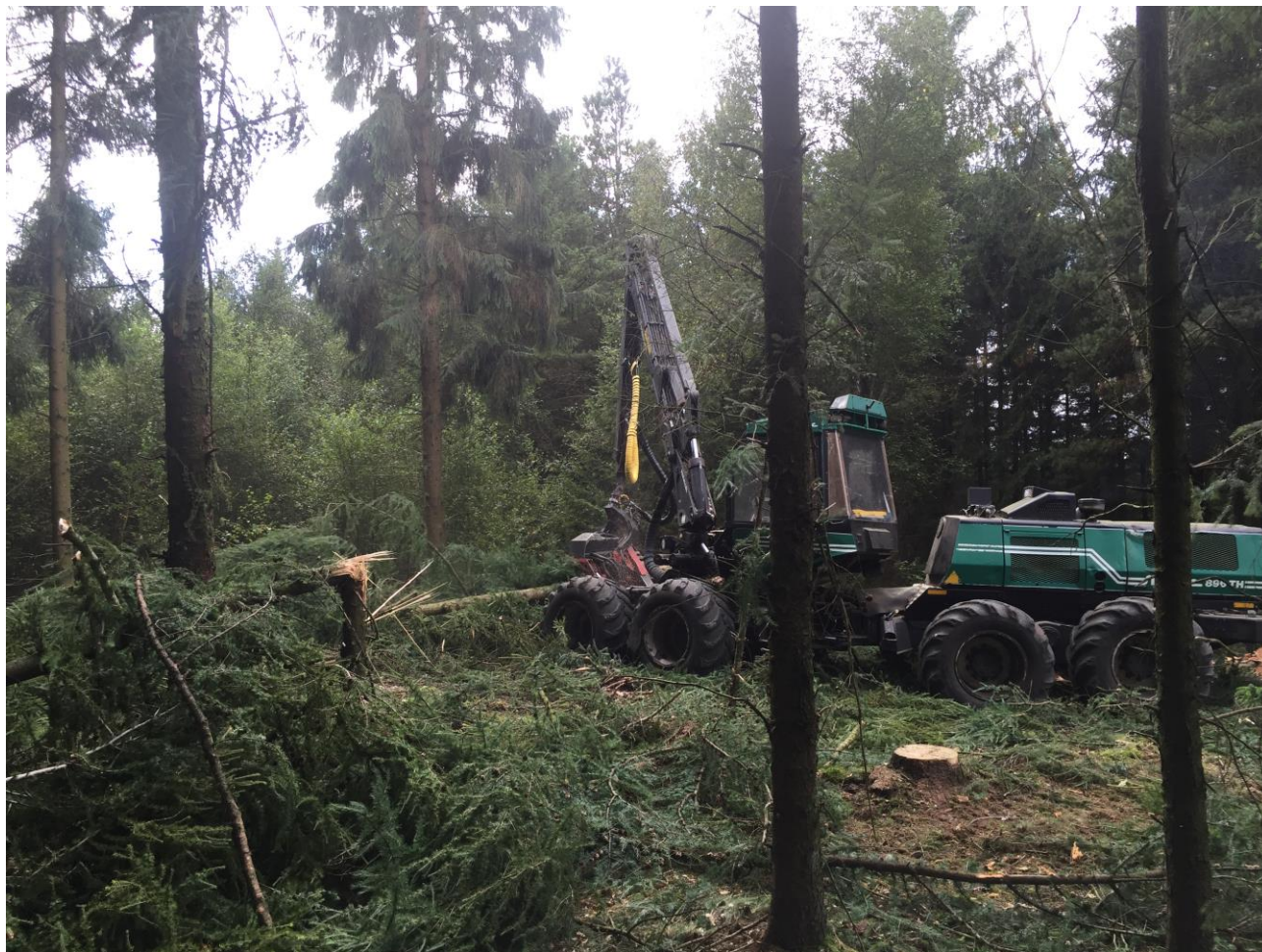
Figur 4: Afdeling 15 i Staushede Plantage. Nu skoves der, og der laves dermed en såkaldt "afdrift", det vil sige, at alle stammerne fjernes på et areal. Moderne computerteknologi inde i maskinen sørger for, at træerne apteres, så det er mest optimalt for skovens økonomi. Salgspriserne er for tiden gode.
